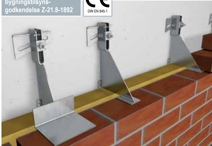
▲ MOSO® murkonsol med enkeltbeslag EK-W som første konsol efter en dilatationsfuge
