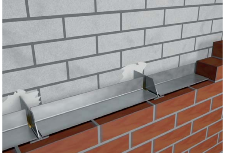
▲ Wandabfangung mit dem MOSO® Einzelkonsolanker EK-M
