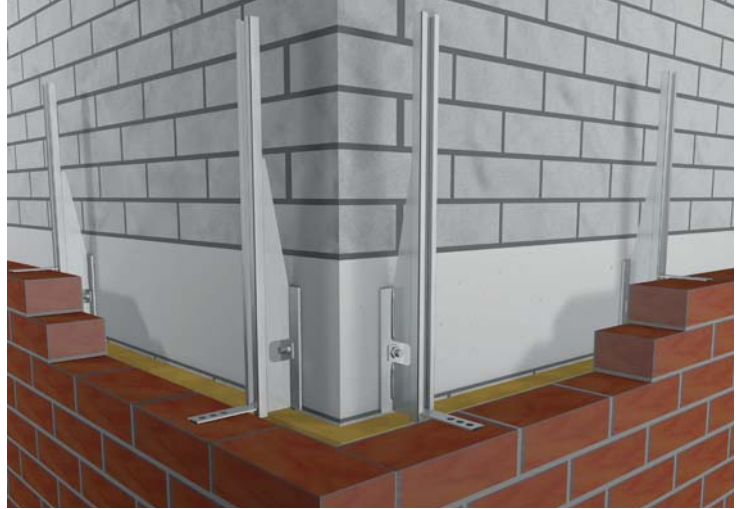
▲ Attikaverankerung mit MOSO® Horizontalverbindung HV-A
