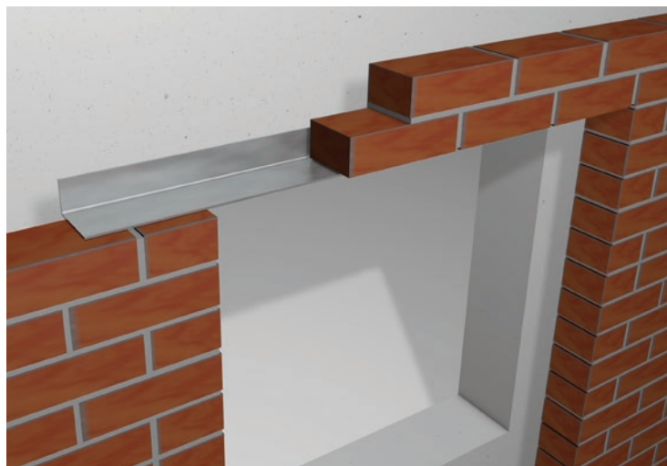
▲ Overliggeroverdækning med MOSO® vinkelunderstøtning WA-Ü
